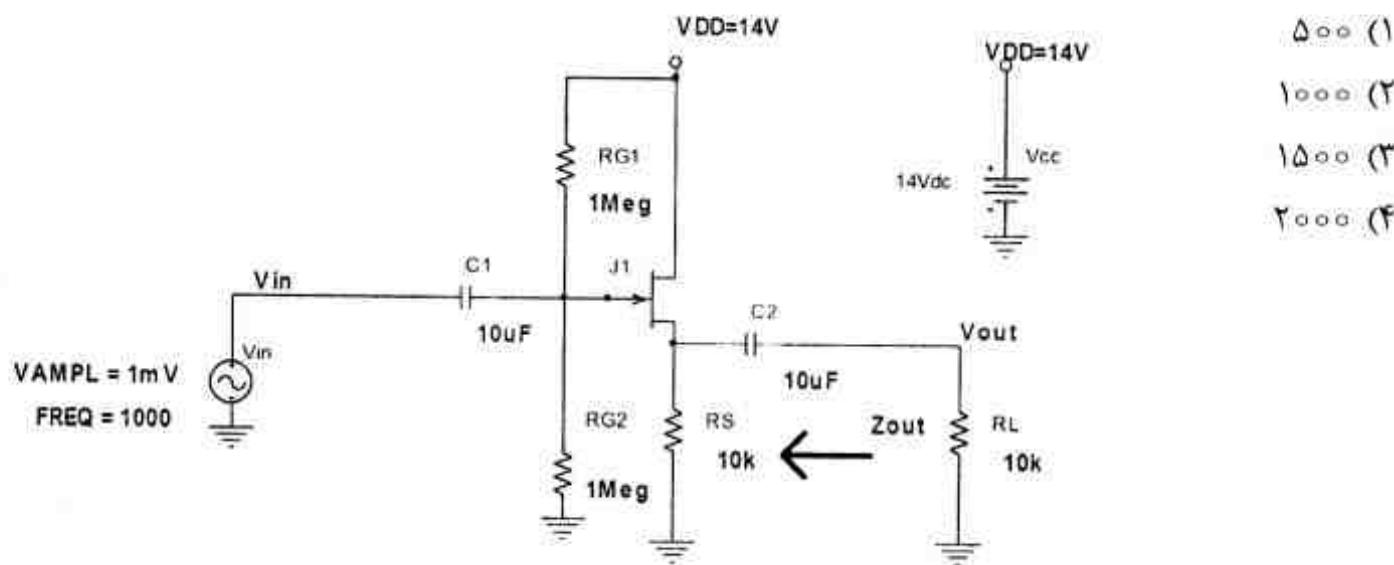
۱۳۵- بهره ولتاژ  $\frac{V_{out}}{V_{in}}$  در مدار شکل زیر به کدامیک از مقادیر زیر نزدیکتر است؟ برای ترانزیستور ( $gm = 300 \mu S$ ,  $rd = 10 k\Omega$ ) فرض شود.
