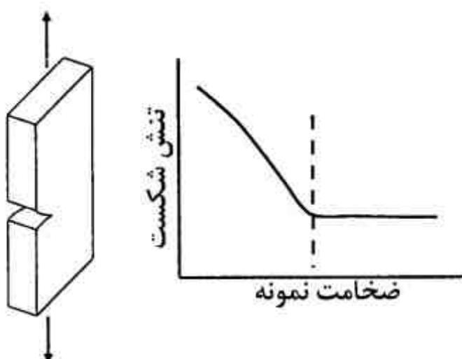
(۱) وجود ترک در نمونه‌های ضخیم خطرناک‌تر است. سطح شکست در نمونه ضخیم به صورت مسطح و در نمونه نازک دارای دو وجه برشی با زاویه  $45^{\circ}$  نسبت به مقطع نمونه است.
