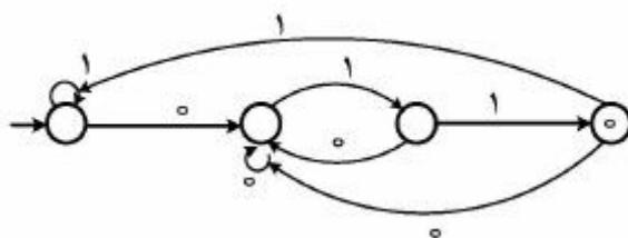
$(\circ + 1)^* \circ 11$  (۱) $(\circ + 1)^* (\circ 11)^+$  (۲) $((\circ + 1)^* \circ 11)^*$  (۳) $(\circ + 1)^* \circ 11 (\circ + 1)^*$  (۴)
