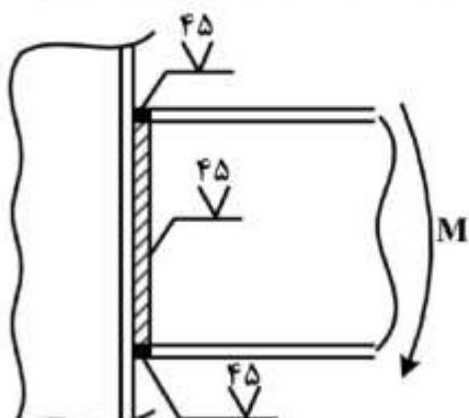
۱۱۳- در اتصال زیر از پیچ‌های اتکائی توأم با جوش گوشه مطابق شکل استفاده شده است. مقاومت برشی هر پیچ ۲ تن و مجموع مقاومت برشی جوش‌های گوشه ۱۵ تن است. مقاومت برشی اتصال چند تن است؟
