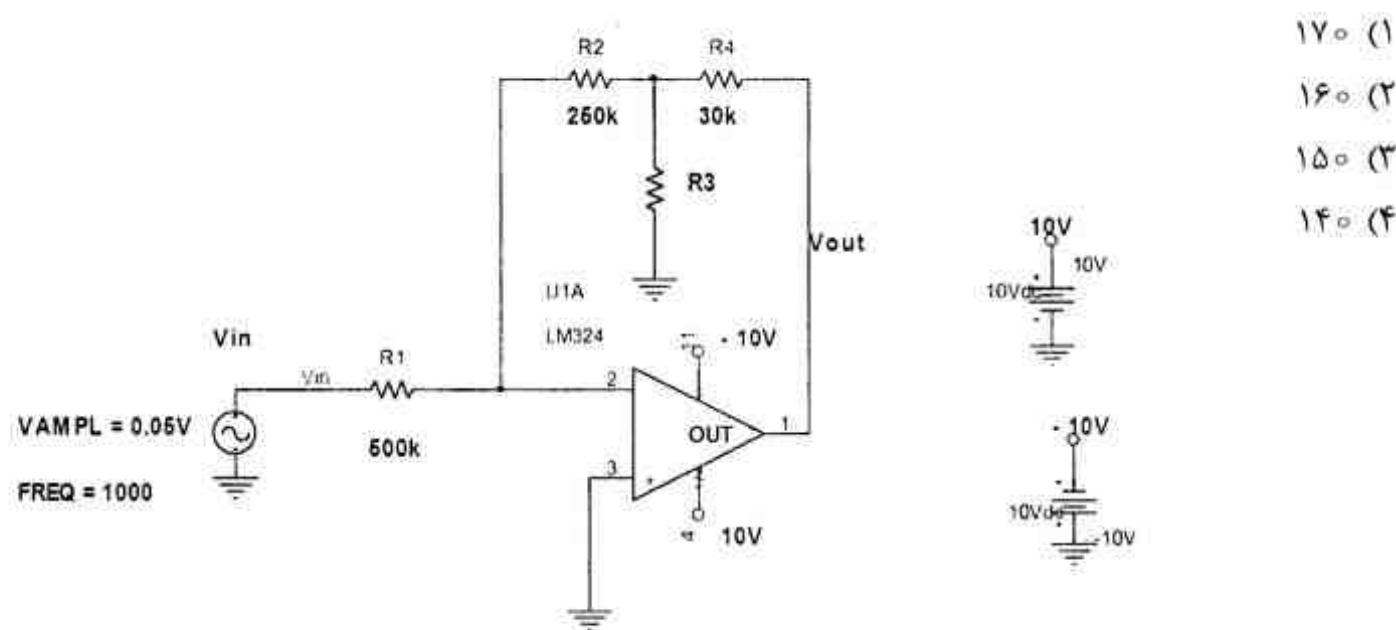
۱۲۵- فاصله مرز های تغییرات ولتاژ در حلقه هیستریسیس ولتاژ خروجی در مدار زیر به کدامیک از مقادیر زیر (بر حسب V) نزدیکتر است؟
