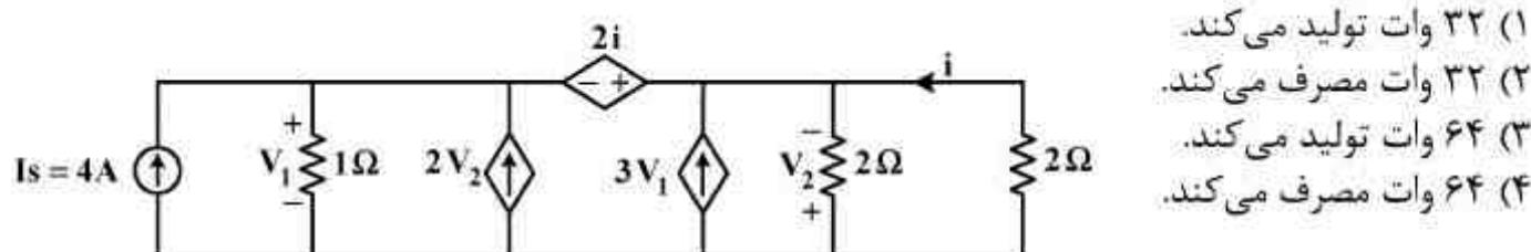
۱۰۳ - در مدار رو به رو، اگر به سمت بی‌نهایت برود در مدار معادل تونن دیده شده در سرهای A و B بر  $R_{th}$  و  $V_{th}$  بر حسب ولت، کدام است؟
