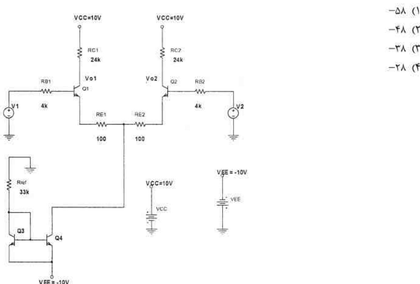
۱۲۹- بهره حالت مشترک (common mode gain) برای هریک از خروجی های نا متقارن  $V_{o2}$  و  $V_{o1}$  آمپلی فایر تفاضلی شکل زیر برابر با کدامیک از مقادیر زیر است؟ اندازه ولتاژ ایرلی ( $V_A$ ) ترانزیستور  $Q_4$  و دیگر مشخصات ترانزیستورها عبارت است از:
